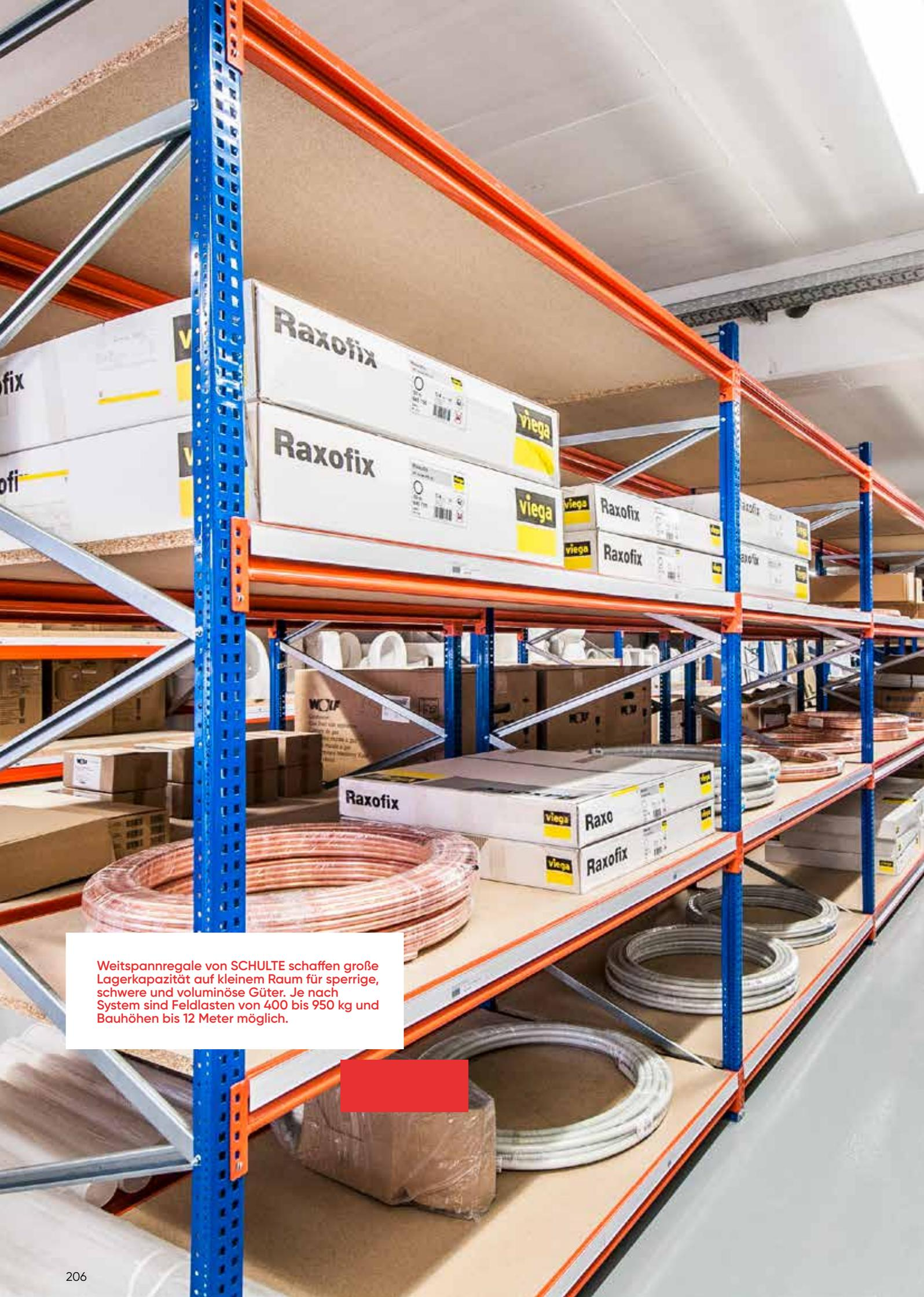
Weitspannregale von SCHULTE schaffen große Lagerkapazität auf kleinem Raum für sperrige, schwere und voluminöse Güter. Je nach System sind Feldlasten von 400 bis 950 kg und Bauhöhen bis 12 Meter möglich.
