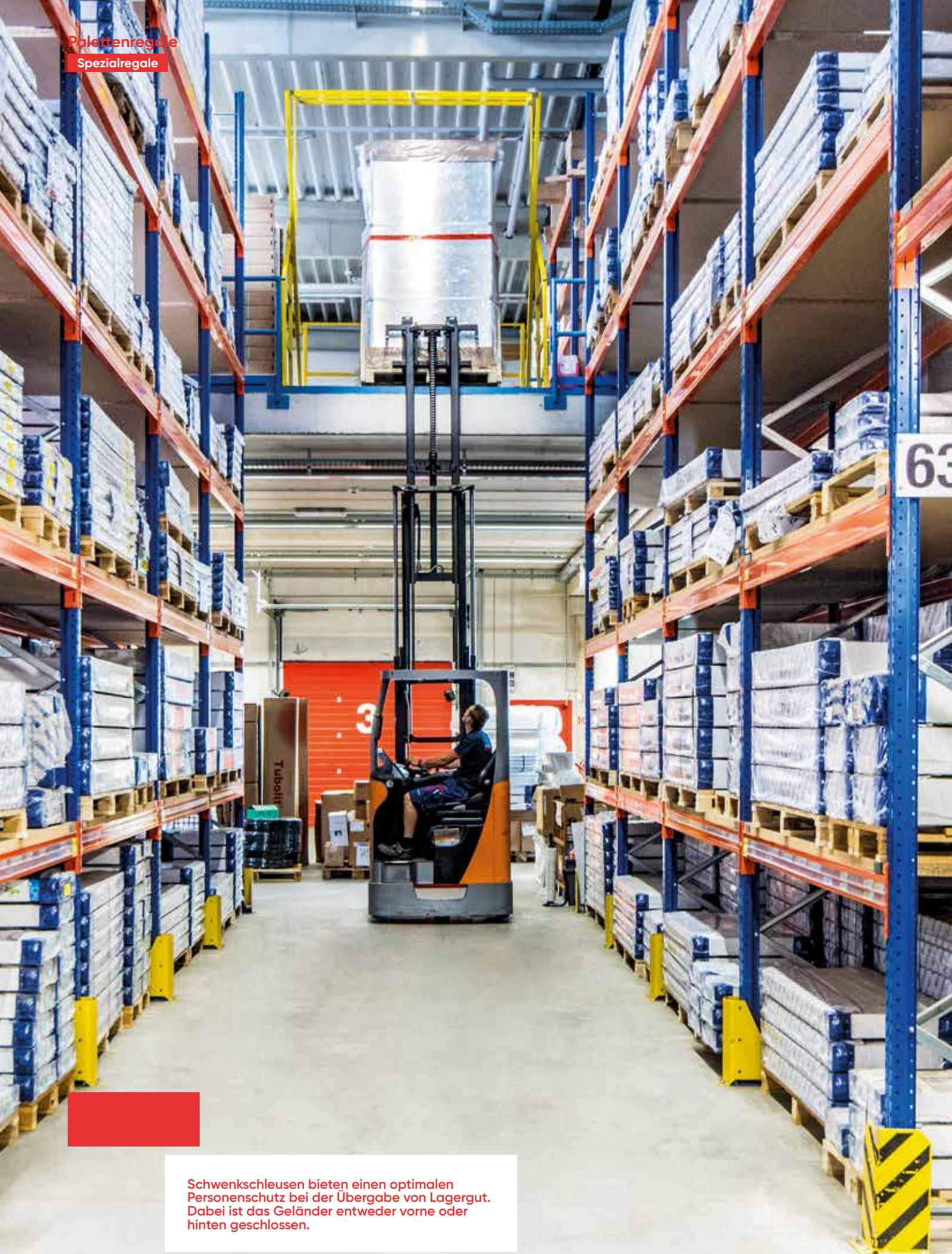
Schwenkschleusen bieten einen optimalen Personenschutz bei der Übergabe von Lagergut. Dabei ist das Gelände entweder vorne oder hinten geschlossen.
